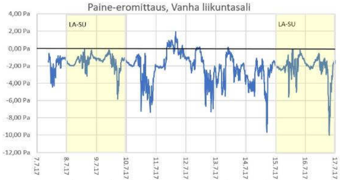
Kuva 145. Vanhan liikuntasalin paine-eromittaukset suhteessa ulkoilmaan 7.7.2017 – 17.7.2017.
