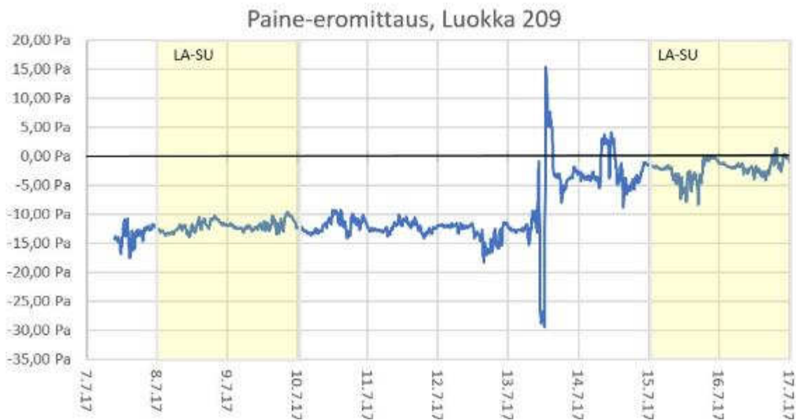
Kuva 146. Luokan 209 paine-eromittaukset suhteessa ulkoilmaan 7.7.2017 – 17.7.2017.
