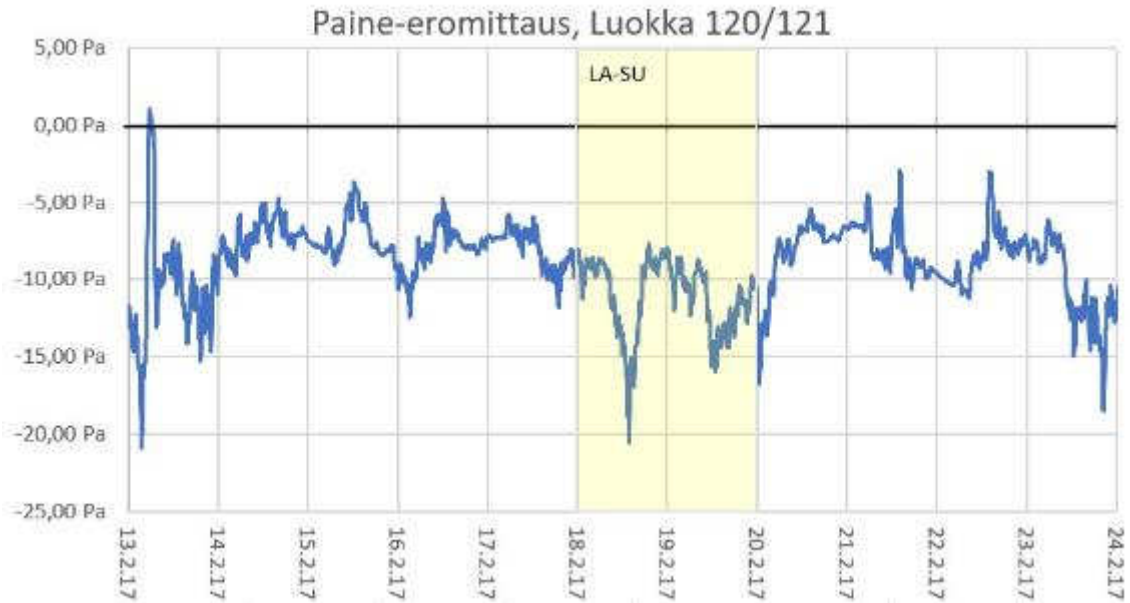
Kuva 149. Luokan 120/121 paine-eromittaukset suhteessa ulkoilmaan 13.2. – 24.2.2016 välisenä aikana.
