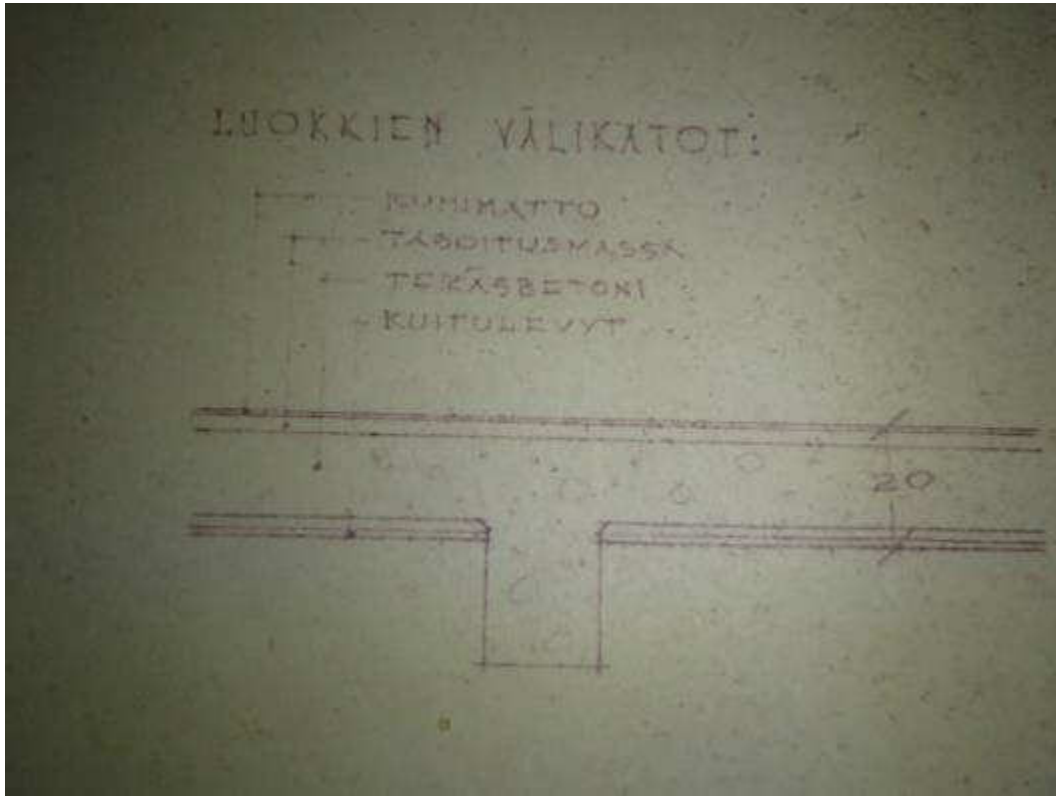
Kuva 47. Alkuperäisten suunnitelmien mukaiset rakennekerrokset luokkahuoneiden välillä.
