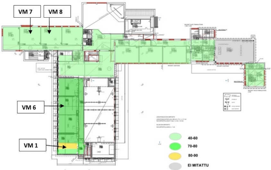
Kuva 136. Toisen kerroksen pintakosteuskartoitus ja viiltomittauskohdat.
