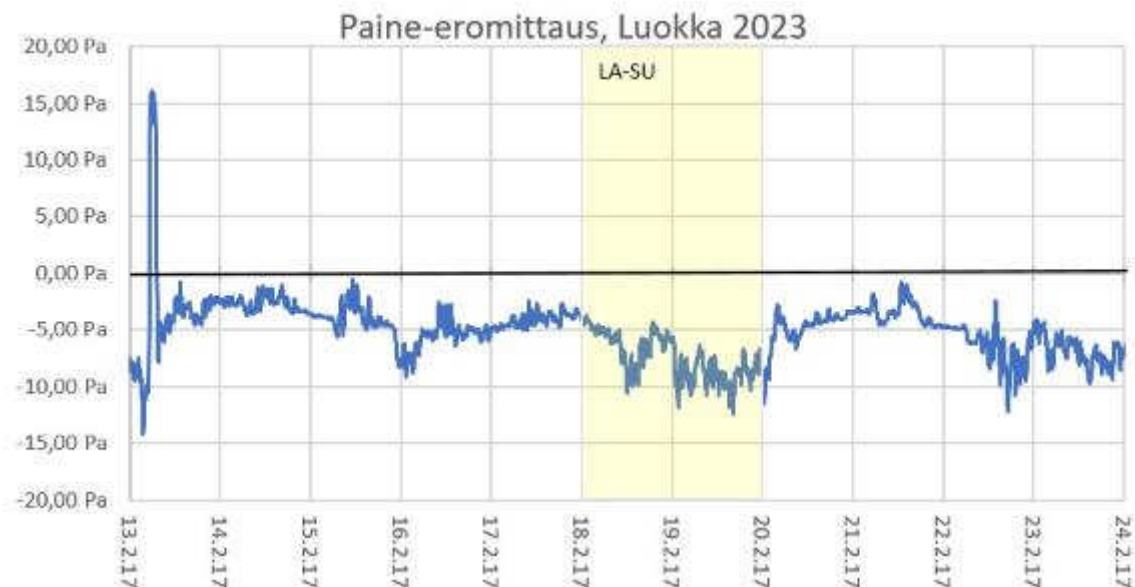
Kuva 152. Luokan 2003 paine-eromittaukset suhteessa ulkoilmaan 13.2. – 24.2.2016 välisenä aikana.
